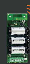
MATRIX 10020015 Universele module, excl. batterij 18022 CR123A batterij
